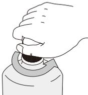
樹脂キャップを矢印(左)の方向に強く廻して開けてください。開栓しますと分注器が装着してあります。
